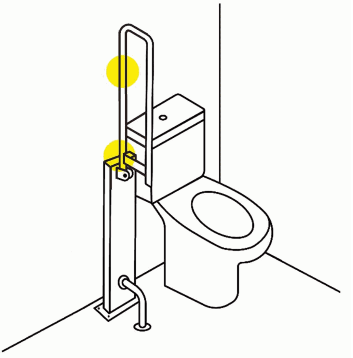
Рисунок А.18 - Откидной поручень без устройства фиксации в вертикальном положении недопустим
