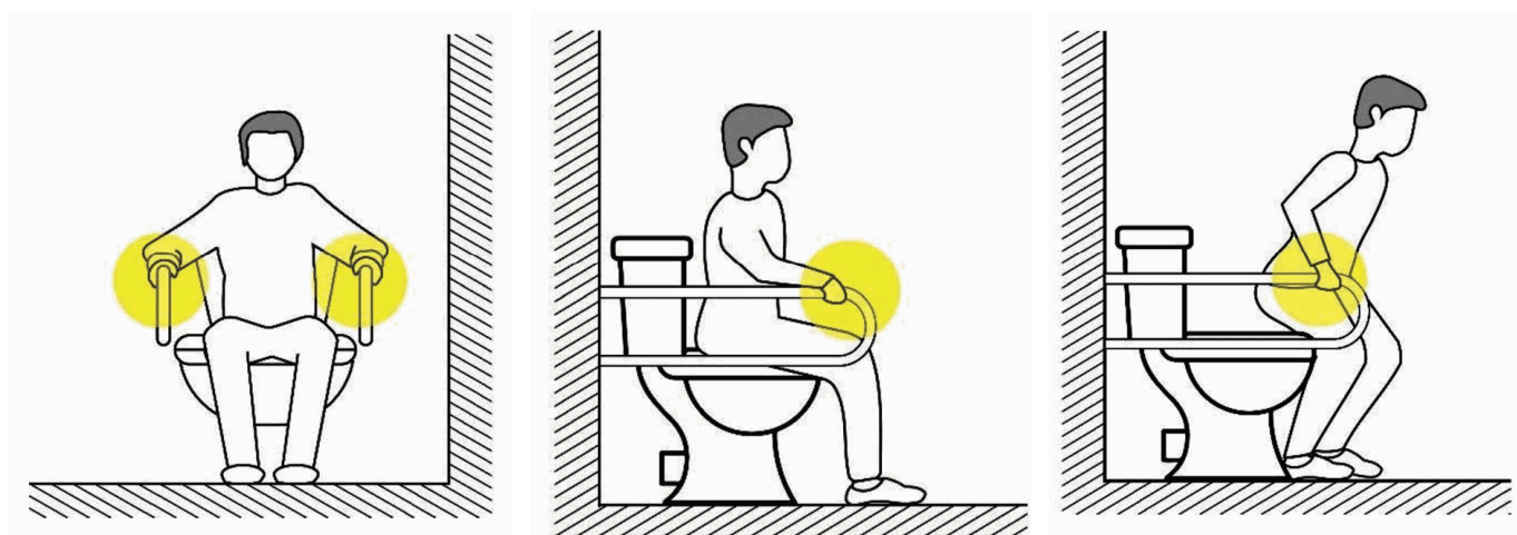
Рисунок А.6 - Использование выступающей за передний край унитаза части горизонтального поручня при вставании с унитаза
