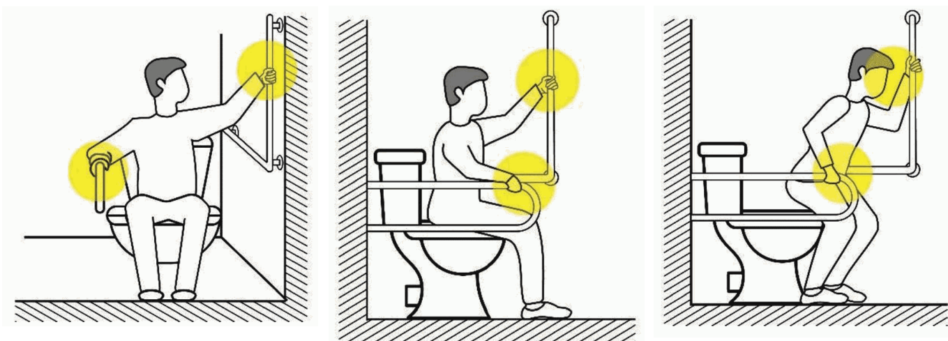
Рисунок А.5 - Использование вертикального поручня при вставании с унитаза
